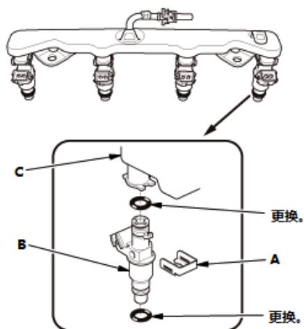
1. 从喷油器 (B) 上拆下喷油器卡夹 (A)。
